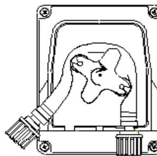
Разблокировать полностью разъем с левой стороны, удерживая его в натянутом положении, и повернуть ручку в направлении, указанном стрелкой, так, чтобы освободить трубку до соединения справа
