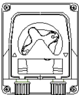
Сдвинуть крышку потянув вверх крепление слева
