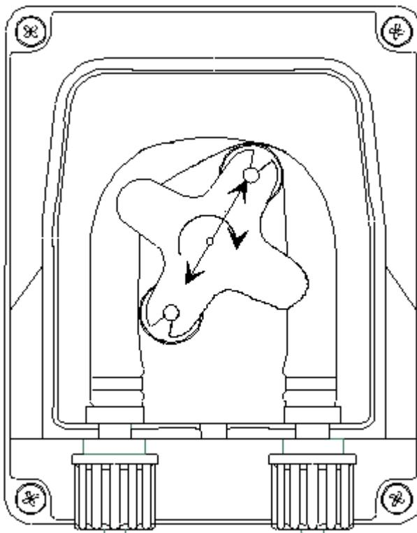
Если нужно положить регулировочное устройство на хранение, рекомендуется прокачать через шланг чистую воду, чтобы его промыть.
