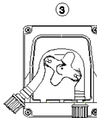
Разблокировать полностью разъем с левой стороны, удерживая его в натянутом положении, и повернуть ручку в направлении, указанном стрелкой, так, чтобы освободить трубку до соединения справа
