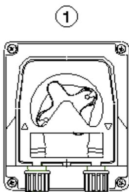
Сдвинуть крышку потянув вверх крепление слева
