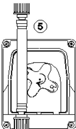
Вставить левый разъем в соответствующее гнездо и пропустить трубку под направляющей ручки. Вращать держатель датчика в направлении, указанном стрелкой, одновременно подводя трубку к голове насоса, до достижения правого разъема
