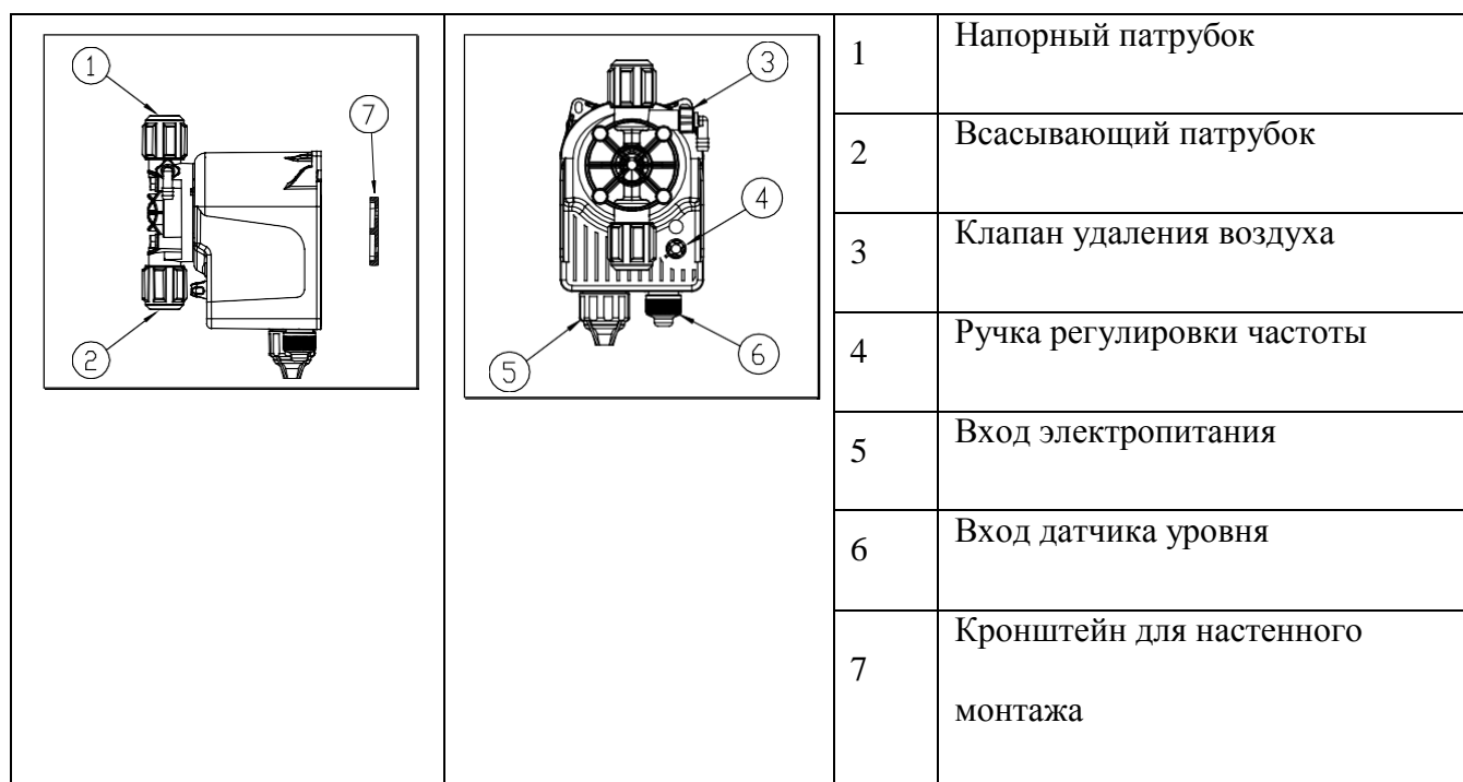
Рис. 10. Составные части насоса
