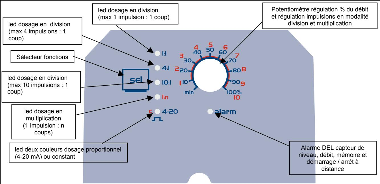
Les régulations doivent être effectuées en utilisant la poignée de réglage placée sur la face avant de la pompe
